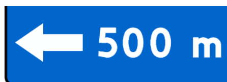
Rys. 4.4.2. Przykładowy sposób umieszczania odległości w dolnej części znaku D-201 na dojeździe do parkingu oddalonego od drogi, gdzie: a – dojazd w prawo, b – dojazd w lewo
