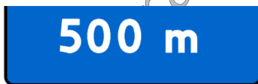
Rys. 4.4.4. Przykładowy sposób umieszczenia odległości na znaku D-201 wskazującego informację o dojeździe do parkingu wydzielonego lub kubaturowego
